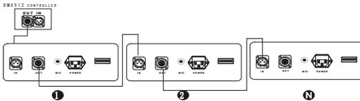
当控台控制信号输入到全彩动画激光表演器时，所有全彩动画激光表演器必须先设置地址码。以便相应的控制信号起作用。这样，当使用任何控制器时，每一
