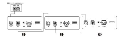
注意:请记住在最后一台灯具的信号输出口连接随机附带的回路插,此回路插在 "CANON (卡龙插)"插头的 2 脚和 3 脚之间连接了 1 个 120 Ω 左右的电阻,连接此回路插可有效地避免 DMX512 信号传输过程中产生的噪音和信号反射现象。
